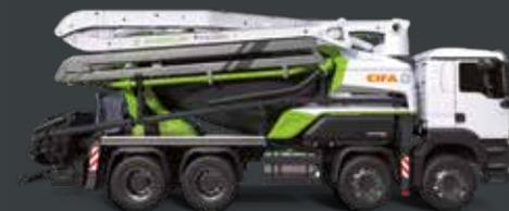
Les fonctions gérées électriquement concernent la rotation du tambour, la stabilisation, l'ouverture/fermeture de la flèche et le pompage.
