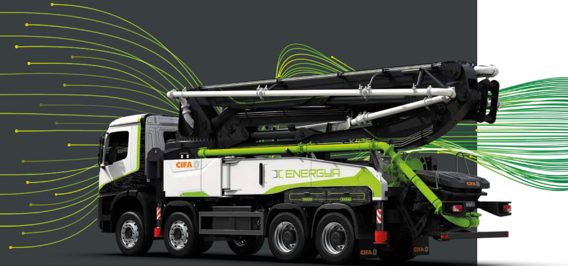
En cas d'absence totale de sources électriques, il est possible de connecter la K42E aux prises de force du camion et donc d'utiliser le moteur du véhicule pour terminer le pompage du béton et fermer la flèche et les stabilisateurs.
